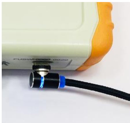
Fuente de alimentación del equipo para cargar la batería. La Luz indica que la batería está en carga
